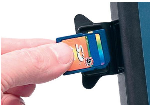
Über die SD-Speicherkarte können Sie die Daten der durchgeführten Arbeiten exportieren, die Konfiguration von einem Monitor auf den anderen Monitor kopieren, die Software der Sämaschine durch Herunterladen der Aktualisierungen direkt von der ARAG Website aktualisieren sowie eine Fernassistenz umsetzen. Ein entsprechender hermetischer Verschluss schützt die Aufnahme des Speichers vor Staub und Wasserspritzern.
