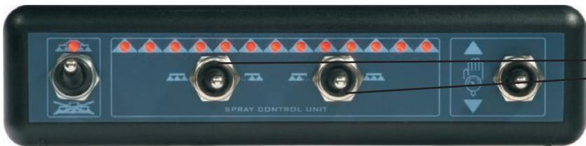
Steuerung von 13 Ventilen über nur zwei Wechselschalter, die für das sequentielle Öffnen und Schließen der Teilbreiten sorgen.
